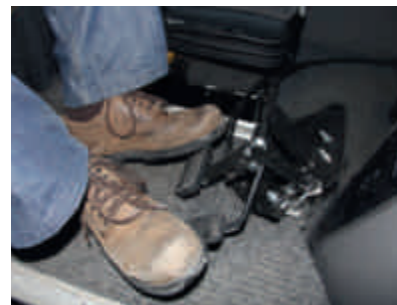
Die Zusatzpedale für den Fahrer in einem Fahrschulbus
